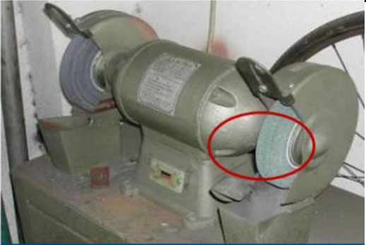
--2.1拆除了安全装置； --2.2安全装置堵塞、失掉了作用；
